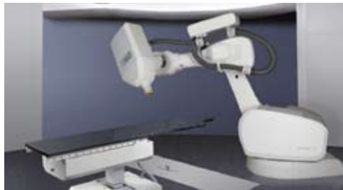
Figure 2 / Le CyberKnife : un accélérateur robotisé pour une radiothérapie de haute précision
